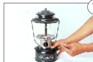
7 点火したらポンピングを20回ほど。タンク内の圧を補い、火力を安定させるためだ。
