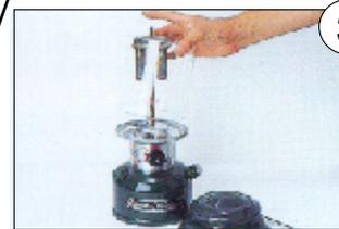
3 上部のボールナットを取り外して、ベンチレーター、グローブを取り外し、マンツル取り付けの準備をする。
