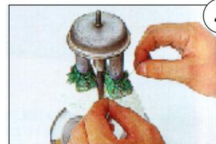
4 マンツルの取り付け。バーナーリングのくびれ部分に付け、余っヒモはカットする。
